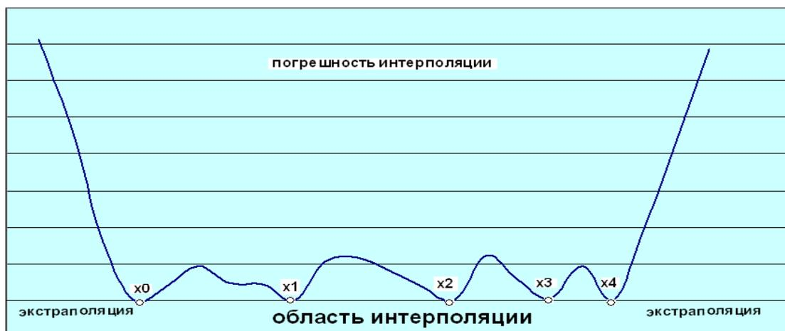
На графике видно, что в узлах интерполяции погрешность равна нулю. Между узлами интерполяции погрешность положительна и не равна нулю, а в областях экстраполяции быстро растет.
